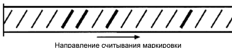
Рисунок 2 - Пример прокатной маркировки предприятия-изготовителя под номером 14
